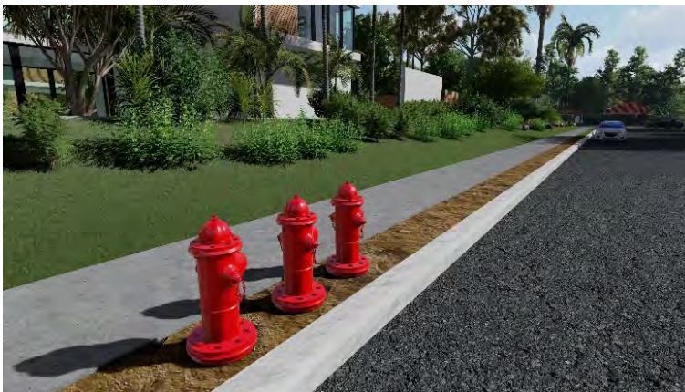
Gambar 9. Ilustrasi penempatan pipa hydrant jalan
