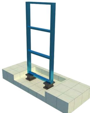
Gambar 8. Ilustrasi struktur yang diberikan *isolation bearing*
